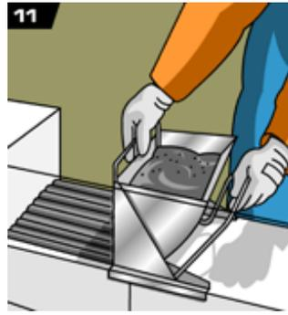
**11.** Приготовленный клей при помощи зубчатой каретки, подбираемой в зависимости от толщины блоков, или шпателя наносится на поверхность 2-3 блоков, не оставляя свободных зон. Каретка дает равномерное распределение клея по поверхности блока (раствор не стекает по бокам блока).
