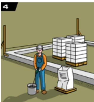
**4.** Для изготовления клея - в ведро с отмеренным количеством воды, при постоянном перемешивании дрелью с мешалкой, постепенно добавляют сухую смесь H+H. В ходе работы клей периодически перемешивают для поддержания однородной консистенции раствора.
