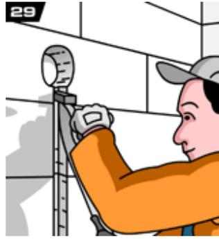
**29.** Канавки для скрытого монтажа инженерных сетей выполняются при помощи ручного или электрического штрабореза. Отверстия под монтажные коробки вырезаются с помощью электродрели со специальной фрезой.
