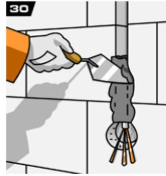
**30.** После разводки инженерных сетей канавки заполняются цементно-песчаным раствором.
