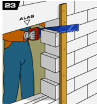
**23.** Для точного выреза оконного проема применяется направляющая рейка, выставленная и закрепленная по размеру проема.
