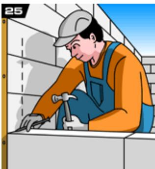
**25.** В каждом втором ряду необходимо связывать внутреннюю и боковую стены. Для этого применяются алюминиевые или нержавеющие стержни (гвозди). Также можно использовать нержавеющие анкера/скобы, ранее вмурованные в боковую стену или оцинкованную перфополосу.
